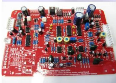
Плата управления для блока генерации коронатора.
