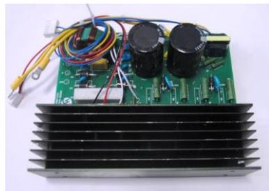
Силовая плата для блока генерации коронатора.
