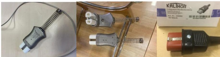
Кабель для наращивания термопар (компенсационный) тип J (ТЖК) FeConst):
