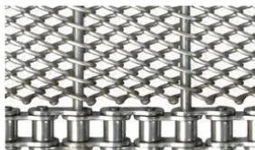
**Сетки металлические** транспортерные из углеродистых, нержавеющей и жаростойких сталей для туннельных печей, линий глазировки, линий заморозки, для упаковщиков продукции в термопленку, для линий подачи стекло и жестетары. Выдерживают температуру от -30до 1200 градусов.
